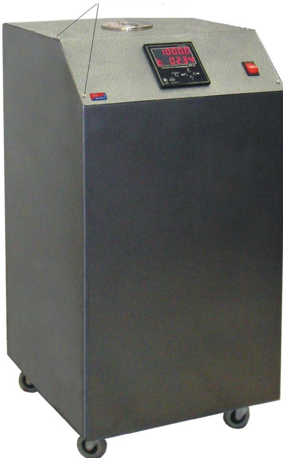
Рисунок 1 - Внешний вид калибратора температуры КТ-3
