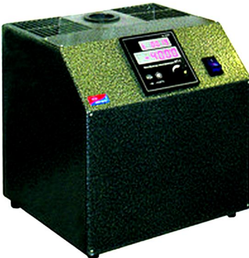
Рисунок 1 - Внешний вид калибратора температуры КТ-1
