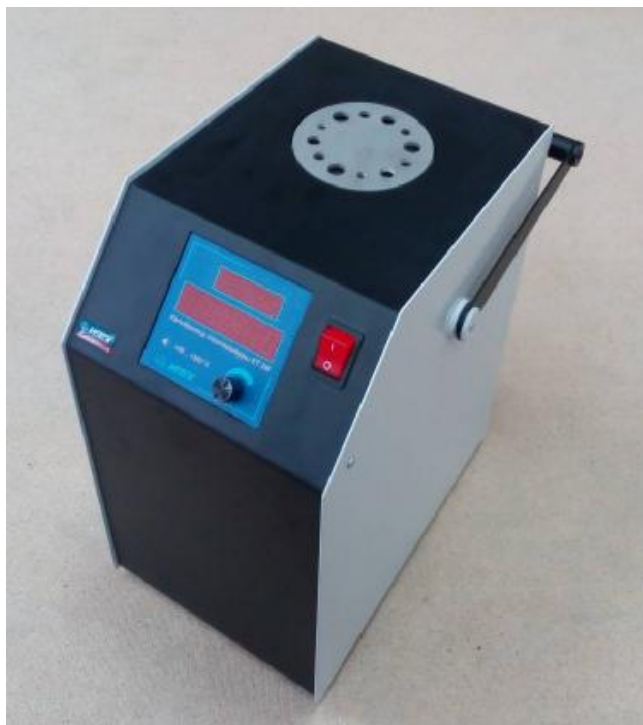
Рисунок 1 – Общий вид калибраторов температуры КТ-2 и КТ-2М
