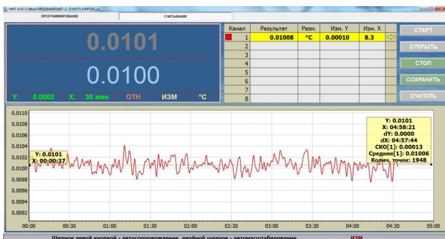
График температурного хода в ампуле тройной точки воды АТТВ-1, измеренного при помощи ПТС-10М (ток питания 1мА) и МИТ 8.15. СКО измерений составило 0.13мК.
